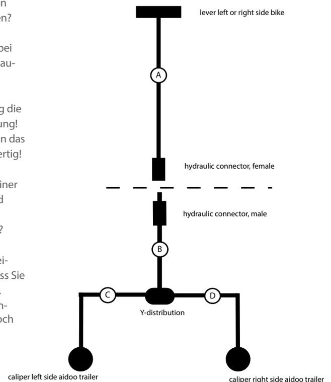
aidoo - Doppelbremsanlage Tektro e-Twin, befüllt
