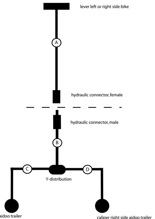
aidoo - Doppelbremsanlage Tektro e-Twin, befüllt
